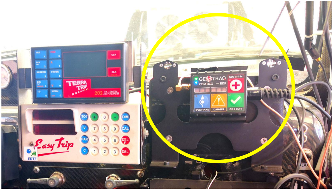
Instalación de la unidad Com-Box con el soporte en el salpicadero mediante tornillos.
