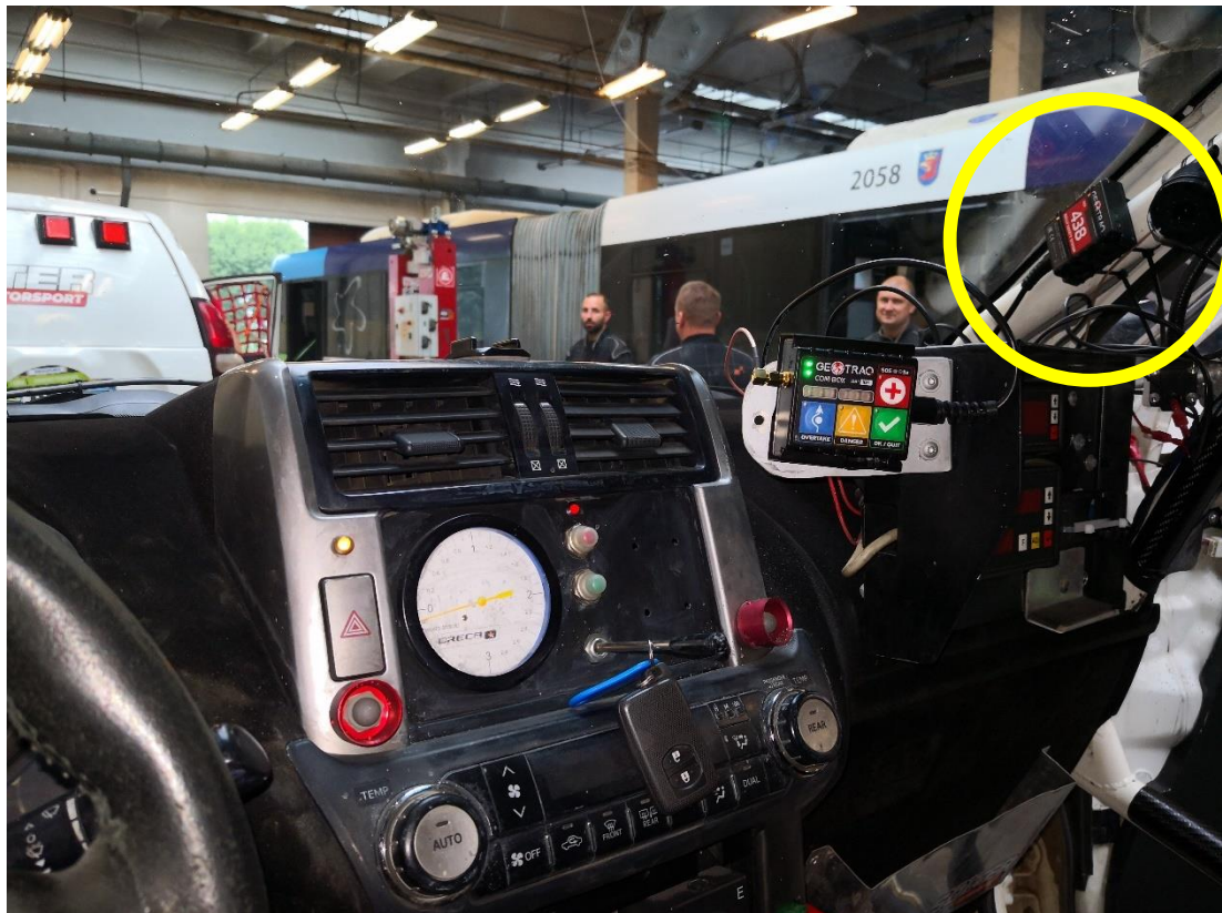
Instalación del GPS TRACKER en la jaula antivuelco "pilar A" de un coche mediante bridas.
